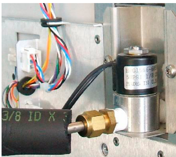
Figura 14 Conexões da válvula de resfriamento criogênico de N 2
